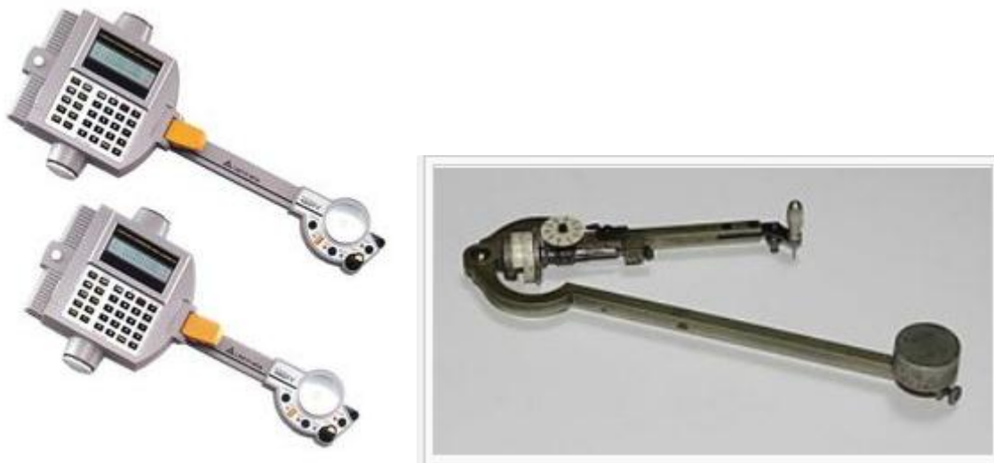
شکل ۲-۱- پلانی متر مکانیکی (سمت راست) و پلانی متر دیجیتال (سمت چپ)
