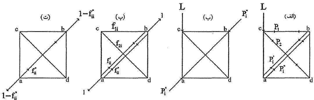
شکل ۱-۱-الف- سازه و بارگذاری، ب- عضو  $i$  با استفاده از نیروهای  $P''_i$  جابه جا می‌شود، پ- نیروهای واحد بر  $a$  و  $b$  اعمال می‌شوند، ت- عضو  $i$  با استفاده از نیروهای  $f''_{ii}$  جابه جا می‌شود [۵]
