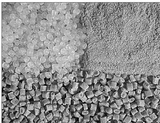
شکل ۱-۲: نمونه‌ای از کامپوزیت چوب و پلی‌اتیلن [۸]
