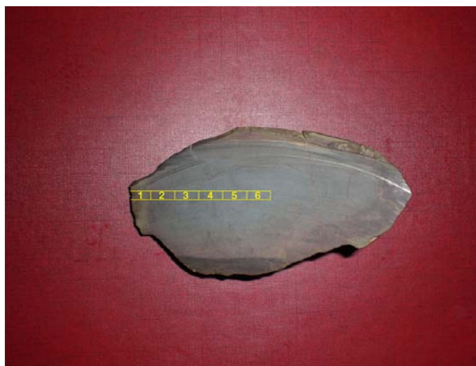
شکل ۱-۲- نقاط نمونه برداری برای آنالیزهای کلسیمتری و پراش اشعه ایکس از حاشیه به مرکز کنکرسون.
