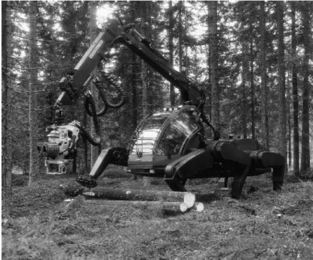
شکل ۳-۱. یک ربات راه‌رونده برای جمع‌آوری الوار در جنگل [۱].
