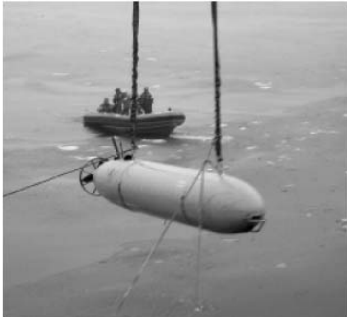
شکل ۱-۶. ربات MBARI ALTEX AUV در حال فرستاده شدن به زیر آب‌های قطب شمال برای انجام تحقیقات علمی [۱].
