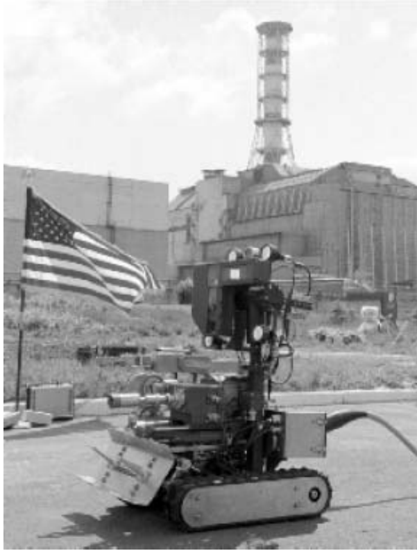
شکل ۱-۵. ربات Pioneer که به منظور اکتشاف و تفحص در چرنوبیل طراحی شده است [۱].
