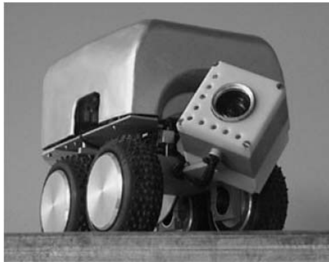
شکل ۴-۱. ربات بازرسی کانال‌های هوا که با دوربین چرخشی خود قابلیت تعقیب دیوار و کنترل اتوماتیک شیب را دارد [۱].
