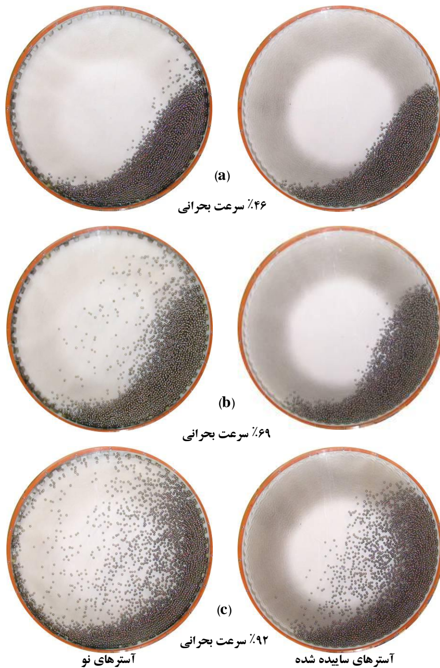
شکل ۱-۱- الگوی جریان در آسیا در سرعت‌های دوران مختلف با آسترهای نو و ساییده شده (یحیایی و بنیسی، ۱۳۹۰)
