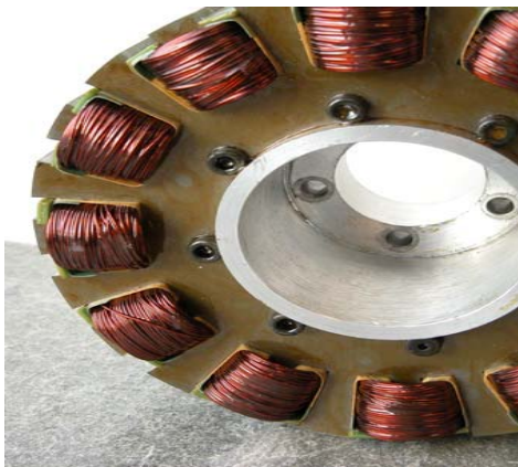
شکل (۳-۱): نمونه کویل قرار گرفته در شیار یک ژنراتور سنکرون.
