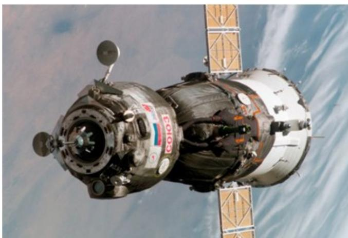
شکل ۱-۳: کپسول سایوز در مدار [۳۹]
