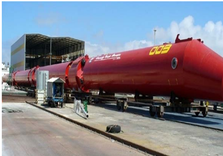
شکل ۱-۷- شماتیکی از پلامیس که از چهار استوانه شناور تشکیل شده است.
