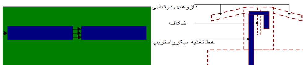
شکل ۱-۲: آنتن دوقطبی با تغذیه میکرواستریپ [۱].
