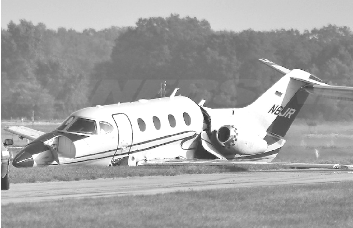
شکل (۱-۱): شکست در بدنه هواپیما در اثر رشد ترک
