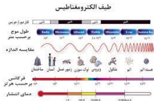
شکل ۱-۱: محدوده امواج الکترومغناطیسی
