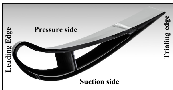
شکل ۱-۳: معرفی قسمت های مختلف یک نازل
