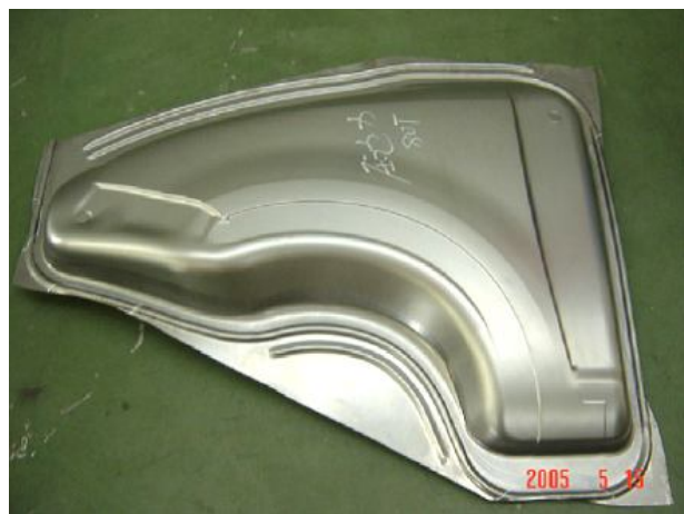
شکل ۱-۱ یک نمونه از قطعات تولید شده در صنایع اتومبیل‌سازی به روش هیدروفرمینگ [۷]
