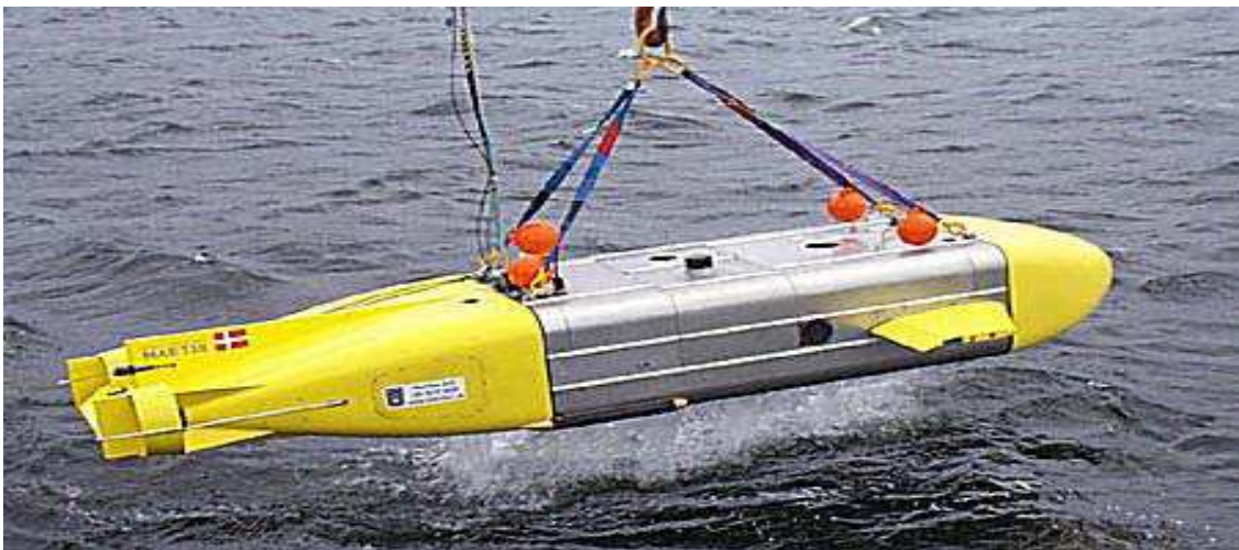
شکل ۱-۲- وسیله خودگردان زیرآبی (AUV) [۱].
