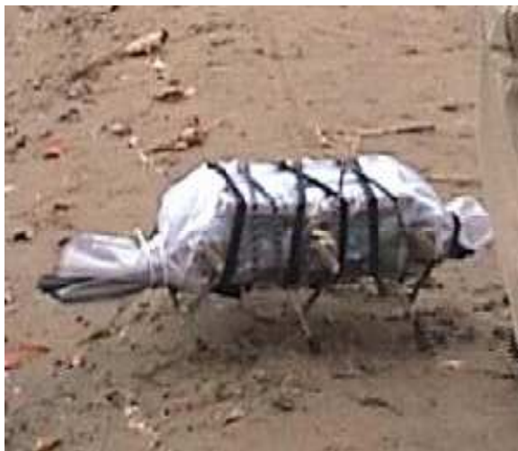
شکل ۱-۷- ربات RHex با کیسه پلاستیکی پوشیده شده [۸].
