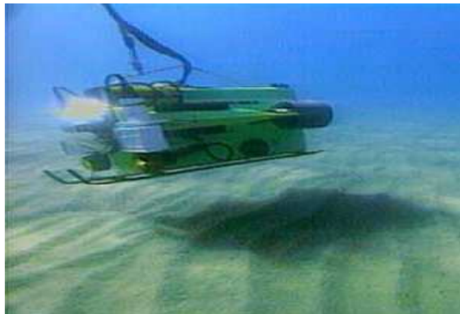
شکل ۱-۱- وسیله از دور کنترل شونده ROV [۱].
