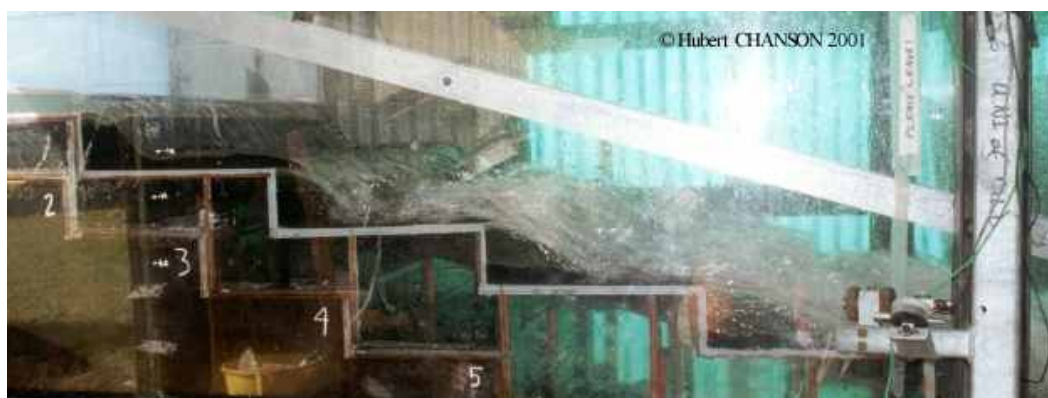
شکل ۱-۶: رژیم جریان ریزشی بر روی سرریزهای پلکانی در آزمایشگاه کویزلند
