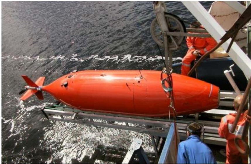
شکل ۱-۴: ربات زیر سطحی هوشمند ۴۵۰۰ Hugin ساخت نروژ [۱۷].
