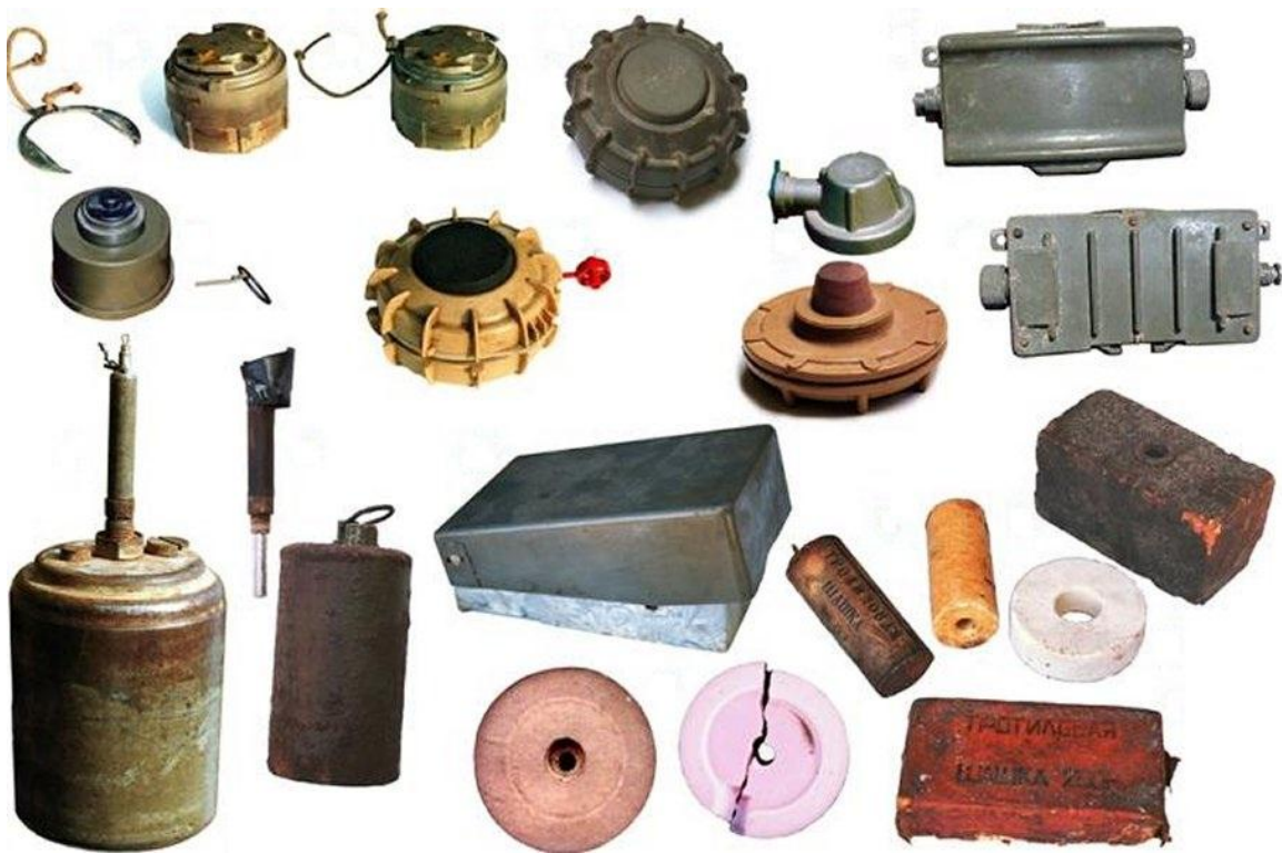
شکل ۱-۲: تعدادی مین ضد نفر به همراه چاشنی و ماده منفجره
