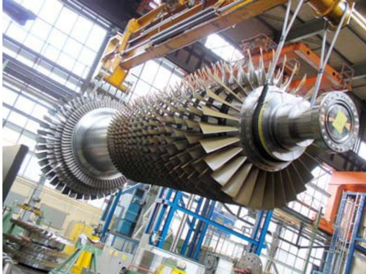
شکل (۱-۲): سیستم دیسک پره‌دار تشکیل شده از چندین مجموعه دیسک و پره [۱]
