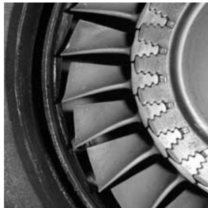
شکل (۱-۳): نمایشی از چگونگی اتصال دیسک و پره
