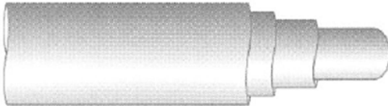
شکل ۱-۵: شماتیک نانو لوله کربنی چند جداره [۲]
