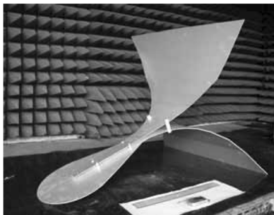
شکل ۶-۱. آنتن شیپوری TEM ساخته شده توسط آقای چانگ
