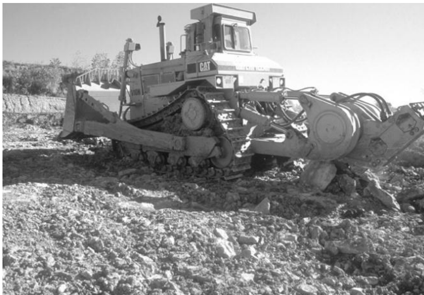
شکل ۱-۲- نمای از یک ریپر زنی در معدن روباز سنگ اهک، کن سیتی، امریکا [۱]
