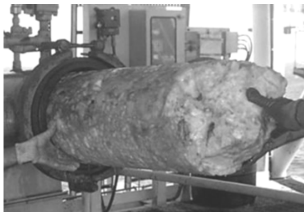
شکل ۱-۱- انسداد لوله انتقال گاز به علت تشکیل هیدرات
