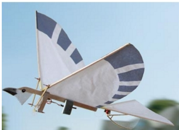
شکل ۱-۴ یک نمونه پرنده بالزن دوباله ساخته شده توسط کرونیستر ۱ [۶]
