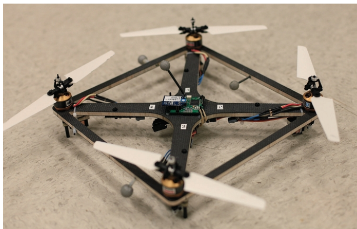
شکل ۱-۶ یک نمونه پرنده بال چرخان با طول ۳۵ سانتیمتر [۸]
