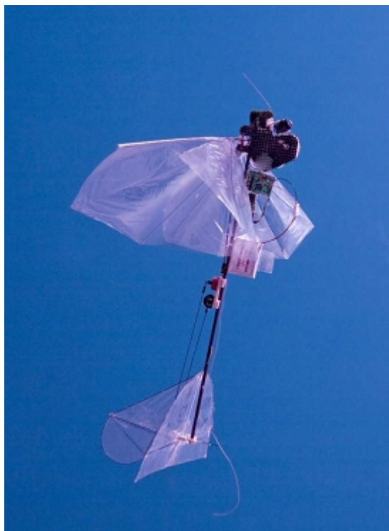
شکل ۱-۳ بالزن چهارباله دلفی ۲ در حال پرواز [۵]
