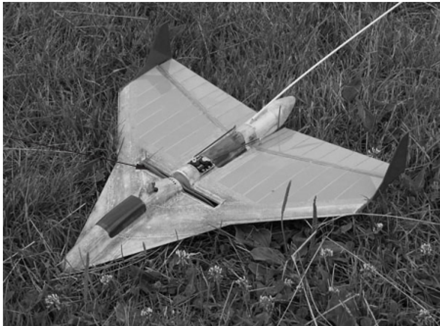
شکل ۱-۲ یک نمونه پرنده بال ثابت با ملخ نصب شده در میانه‌ی بدنه [۴]
