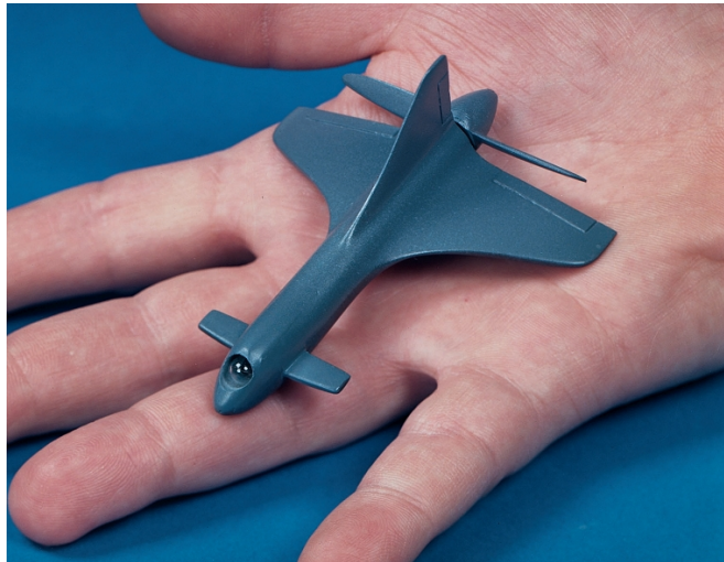
شکل ۱-۱ نمونه‌ای از یک پرنده بال ثابت ساخته شده در آزمایشگاه لینکلن با طول بال ۷/۴ سانتی‌متر [۳]
