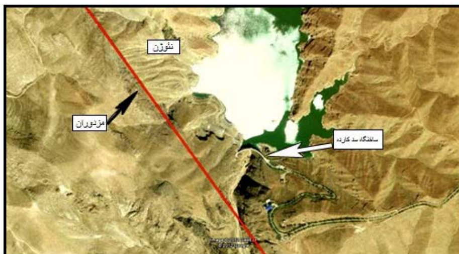
شکل شماره ۴-۱: نمایی از سد کارده که با فلش سفید رنگ نشان داده شده است و همجواری آن با گسل کارده.
