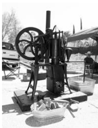
شکل (۱-۴) نخستین موتور استرلینگ کاربردی [۱]
