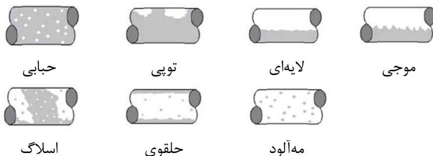
شکل ۱-۱ الگوهای جریان دو فازی مایع - گاز در کانال افقی [1]
