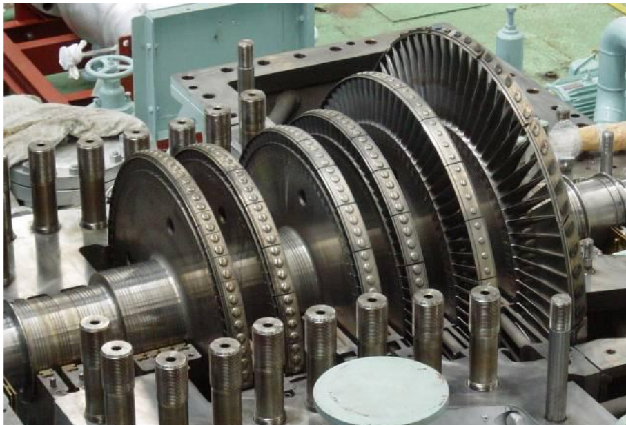
شکل ۱-۱- روتور یک توربین.
