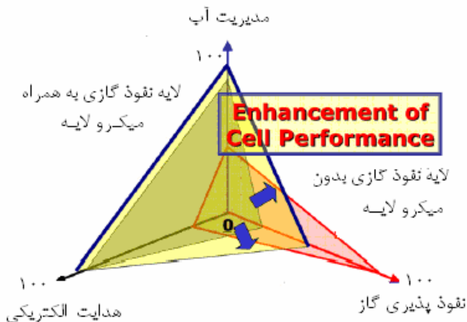
شکل ۱-۳. تاثیر میکرو لایه های متخلخل در لایه نفوذ گازی [۳]
