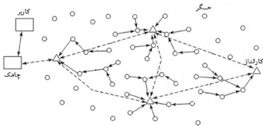
شکل ۱-۲: ساختار کلی شبکه حسگر بی‌سیم
