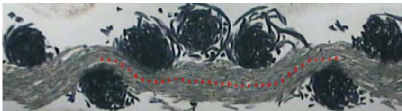
شکل ۱-۲- تصویر سطح مقطع پارچه ی تار ی- پودی [۱]
