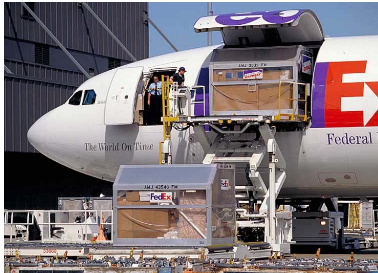
شکل (۱-۵): بارگیری جعبه حمل بار استاندارد LD3 از درب بقل [4]
