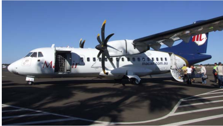
شکل (۱-۷) : وجود درب بارگیری از بقل برای یک هواپیمای با قطر بدنه کم [1]
