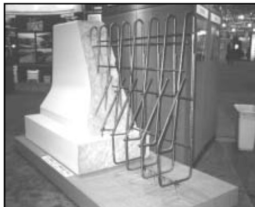
(شکل ۱-۱): استفاده از بتن مقاومت بالا در قطعات پیش ساخته
