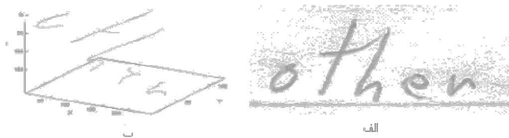
شکل ۱-۱. (الف) ورودی یک سیستم برون‌خط: یک تصویر دیجیتال عادی (ب) حالت برخط: یک سیگنال دوبعدی گسسته شده در حوزه زمان، محور عمودی بیانگر زمان است.
