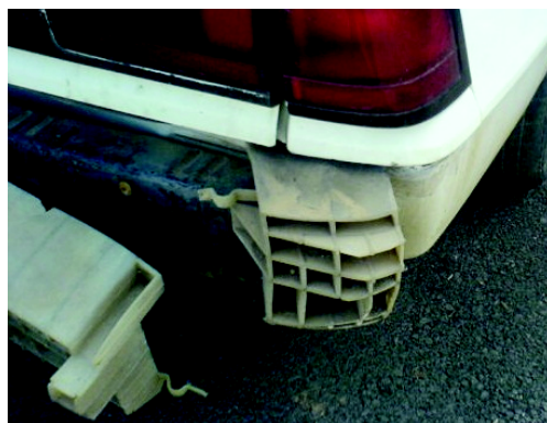
شکل ۱-۲: کاربرد جاذب مربعی به عنوان جاذب انرژی در سپر خودرو
