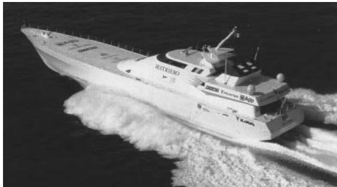
شکل ۲-۳. کشتی جنگی تک دیواره ساخته شده از آلومینیوم ۵۰۸۳ [۱۳].
