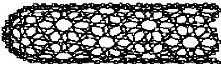
شکل ۶-۱: نانولوله های (الف) صندلی (ب) زیگزاگ (پ) یکدست با کلاهک فولرن
