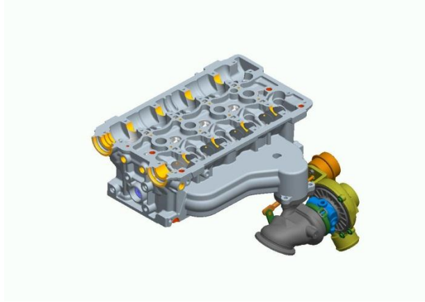
شکل (۲-۳) - با حذف واشر چندراهه خروجی امکان نشت گازهای خروجی از بین می‌رود.
