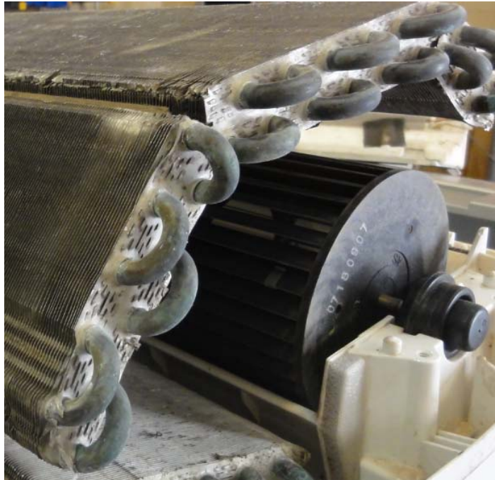
شکل ۲-۱: نمایی از فن جریان متقاطع موجود در واحد داخلی کولر دو تکه
