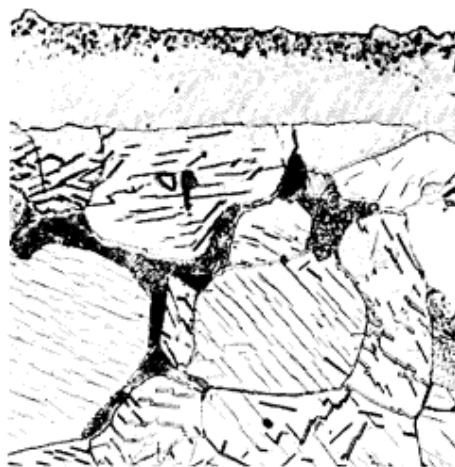
شکل (۲-۴) لایه سخت شده و لایه نفوذی تولید شده توسط نیتروژن دهی مایع سیانید-سیانات [۸].
