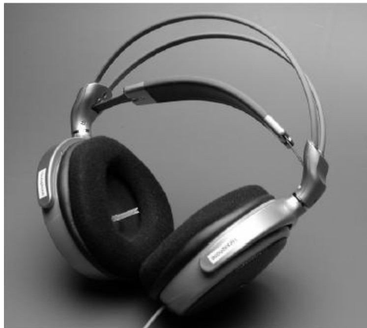
شکل ۲-۱: یک هدفون کاهش نویز الکتریکی.
