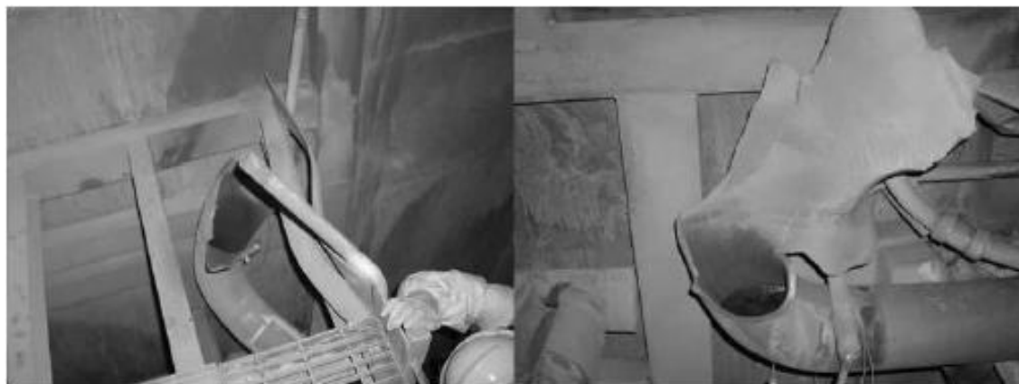
شکل ۱-۵: دو سمت یک لوله گسیخته شده در یکی از نیروگاه‌های هسته‌ای ژاپن [۳]
