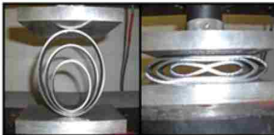
شکل ۷-۱ لوله های با مقطع دایره ای تحت فشار محوری [۶]
