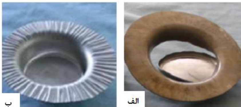
شکل (۱-۲) قطعات کشش عمیق یافته با نیروی ورقگیر نامناسب (الف) نیروی زیاد (ب) نیروی کم [۵].
