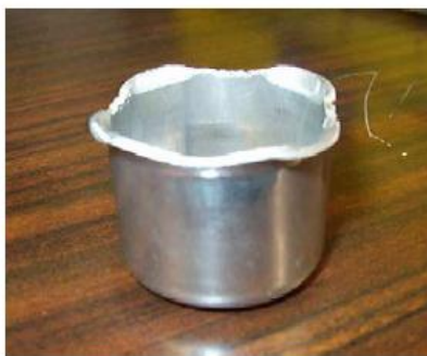
شکل (۱-۴) گوشواره‌ای شدن در فرآیند کشش عمیق [۷].
