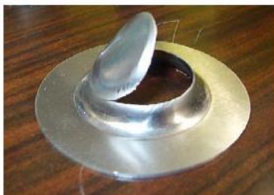
شکل (۱-۵) پارگی در فرآیند کشش عمیق [۷].
