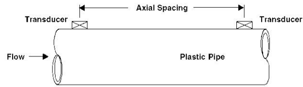
(الف) اولین دبی‌سنج تأخیر انتشار غیرتماسی با ترندیوسر خارج لوله
