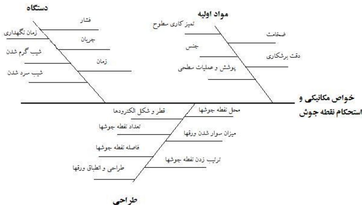
شکل ۱-۱ : نمودار علت و معلولی پارامترهای موثر بر خواص مکانیکی و استحکام نقطه جوش
