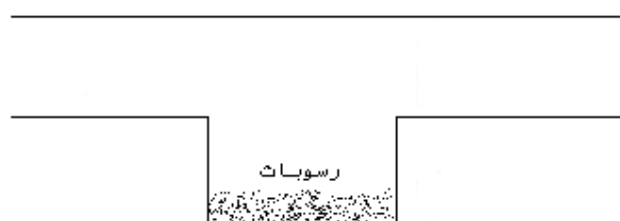
شکل ۱-۳-الف: ته نشین شدن رسوبات در ته مخزن
