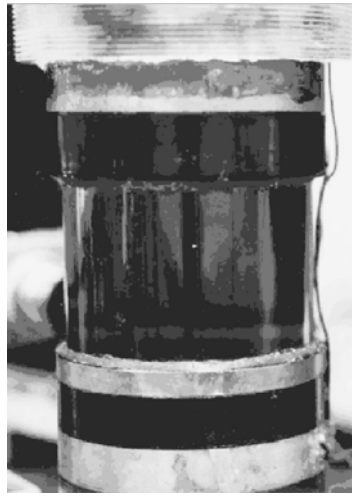
شکل (۱-۱): حباب آوادرخشنده. نقطه‌ی واقع در مرکز ظرف، حباب گسیلنده‌ی نور است [۶].
