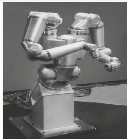
شکل ۱-۴ بازوی ماهر رباتیکی (دارای دو بازو با ۱۷ درجه آزادی)(۵)
