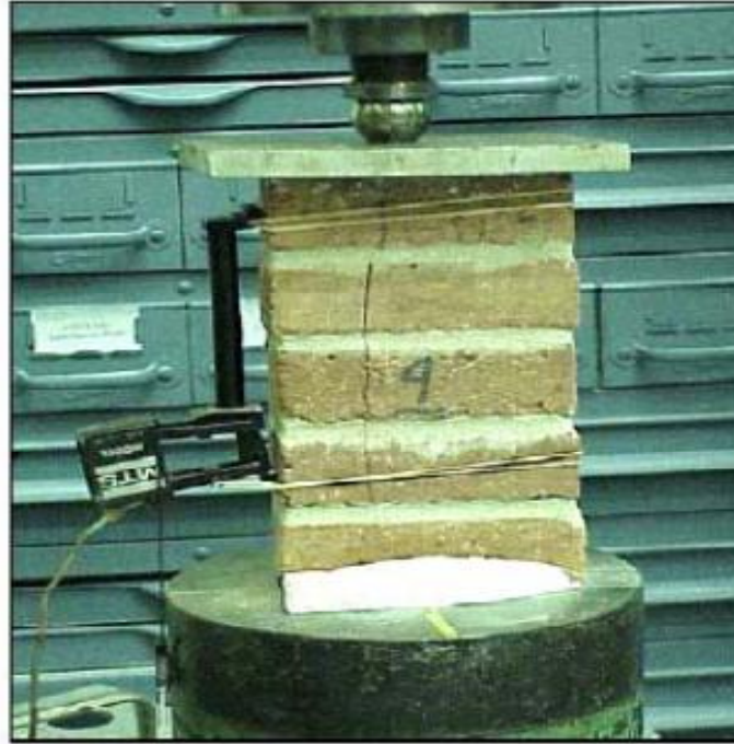
شکل ۱-۳ آزمایش تنش فشاری مصالح بر روی نمونه
